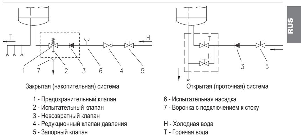
**Нельзя встраивать запорный клапан между нагревателем и возвратным защитным клапаном, так как таким образом Вы сделаете невозможной работу возвратного предохранительного клапана.**
